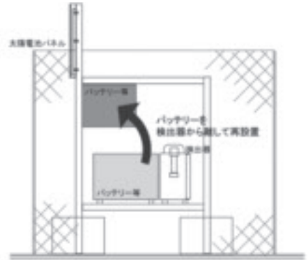
日立アロカメディカル(株)製モニタリングポストの機器調整工事内容
