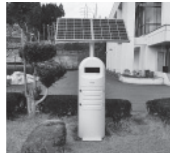
多目的研修集会施設に設置されたリアルタイム線量測定システム
