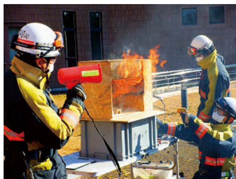
ファイヤーコントロールボックス 燃焼実験の様子
