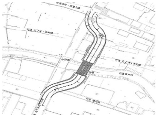
県道船引大越小野線小野橋の迂回平面図
