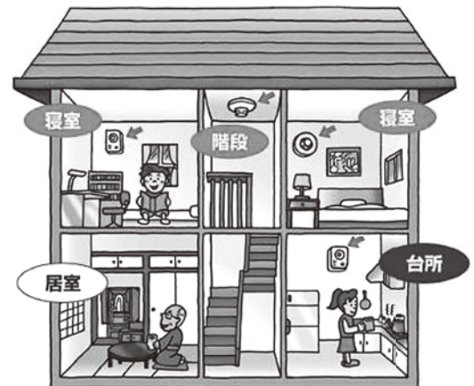
住宅用火災警報器設置場所
